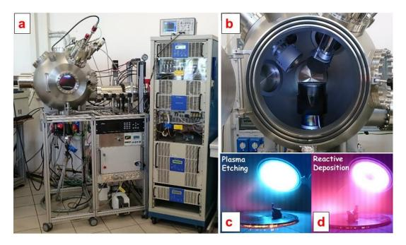
Figure 46: (a) HiPIMS apparatus, (b) HiPIMS chamber, (c) Plasma Etching, (d) Reactive Deposition.
