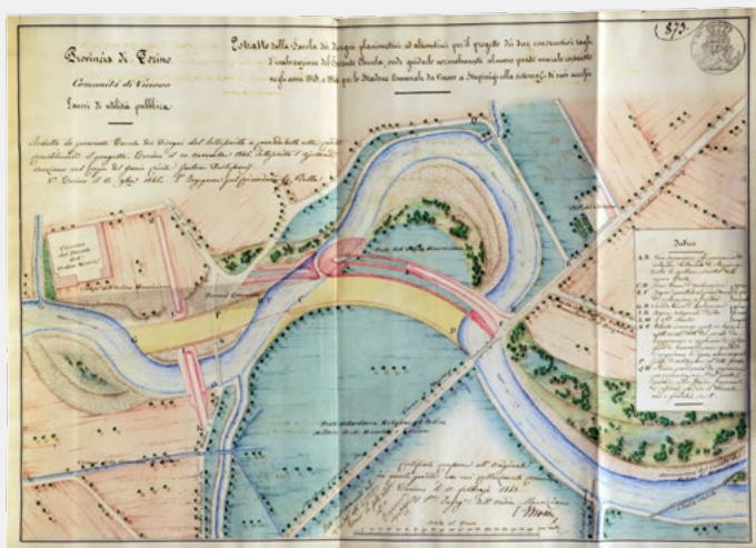
GAETANO DE STEFANIS, Provincia di Torino. Comunità di Vinovo. Lavori di utilità pubblica. Estratto dalla Tavola dei disegni planimetrici ed altimetrici per il progetto di due consecutivi tagli d'invalveazione del Torrente Chisola, onde guidarlo normalmente al nuovo ponte murale costruito negli anni 1845 e 1846 per lo Stradone Comunale da Vinovo a Stupinigi colla sistemaz.e de' suoi accessi, 1848. AOM, Custodia degl'Instrumenti 1850 (13), 1848, c. 873.
