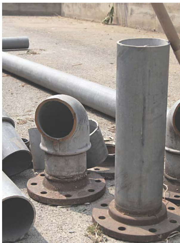
15. I tubi idraulici e le flange recuperate dall'impianto dismesso possono essere reimpiegate, diventeranno le basi dei tavoli dell'area 2 e completeranno le strutture già esistenti per gli ombreggianti dell'area 1.
