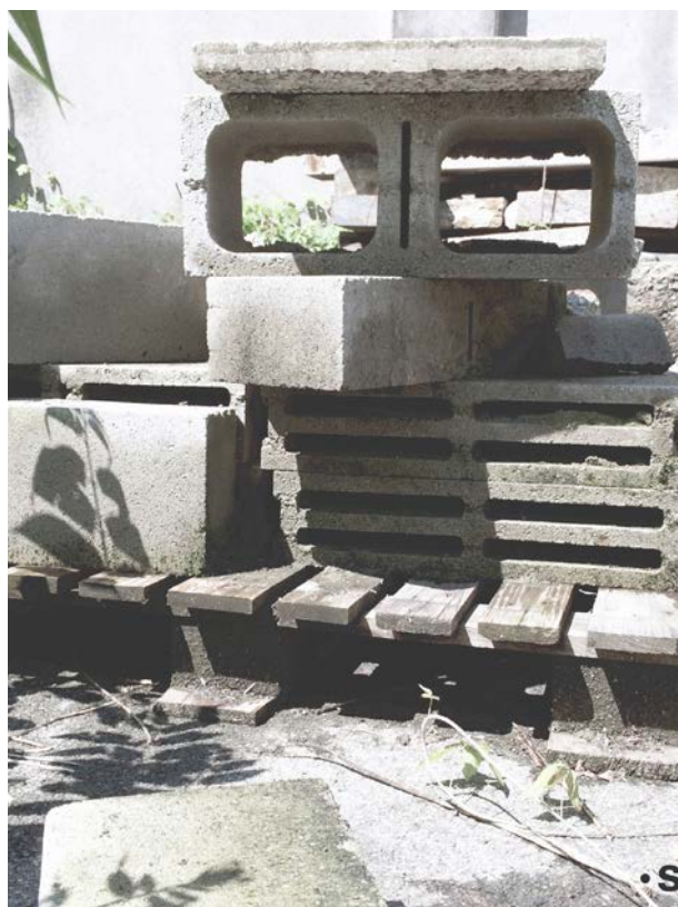
14. In cerca di materiali di recupero da utilizzare per la struttura della pedana e i plinti di panche e tavoli, nell'area 2, si individuano diversi blocchi in laterocemento.
