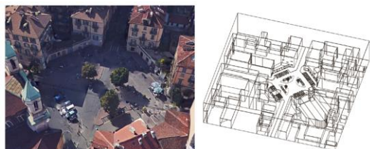
Figura 1 – Immagine aerea di Largo Saluzzo e modello utilizzato per le simulazioni Odeon.
