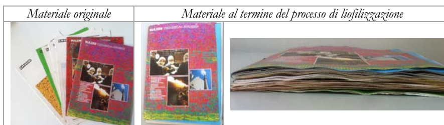
Figura 6. Effetto della liofilizzazione sull'aspetto esteriore di un insieme di brochure patinate (campione 4) sottoposto al processo dopo allagamento (simulato)
