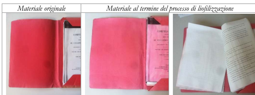
Figura 7. Effetto della liofilizzazione sull'aspetto esteriore di una cartellina con carta stampata (campione 5) sottoposto al processo dopo allagamento (simulato)
