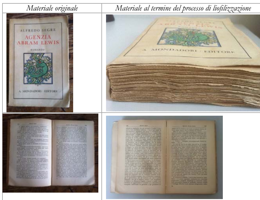
Figura 5. Effetto della liofilizzazione sull'aspetto esteriore di un libro (campione 1) sottoposto al processo dopo allagamento (simulato)
