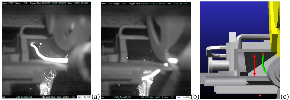
Figura 5. Esempi di ripresa con telecamera ad alta velocità dell'operazione di taglio (a,b) e di modellazione multi-body del sistema (c).
