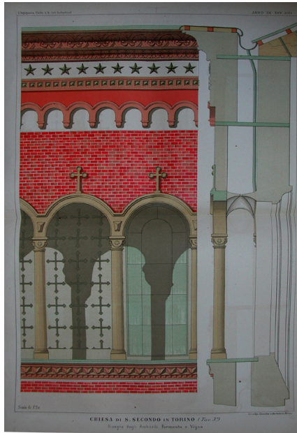
Fig. 3 - Formento e Vigna, dettaglio di prospetto e sezione della chiesa di San Secondo in Torino, Tip. Lit. Camilla e Bertolero. L'Ingegneria Civile e le Arti Industriali, anno IX, 1883, tav. XIII.
