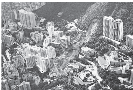
Fig. 7. Vista della frana di Po Shan ad Hong Kong ( www.transportscotland.gov.uk/report/j10107-22.htm ) e vista tridimensionale dell'intervento drenante mediante due gallerie drenanti ( www.tunnelonline.info ) realizzate per il drenaggio della coltre alterata in occasione di eventi piovosi intensi.
