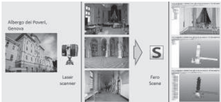
2. Schema relativo all'acquisizione/restituzione dati per creare la nuvola di punti.
