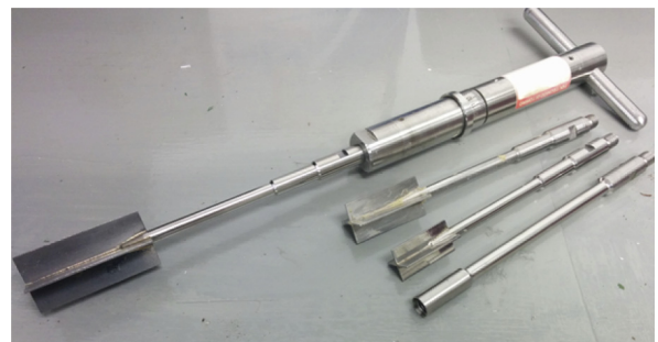
Fig. 6. Vane shear test apparatus.
