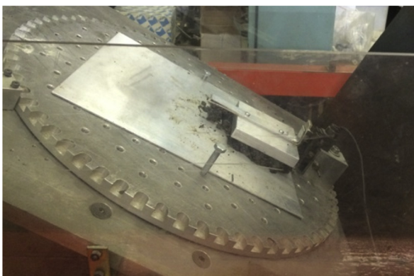
Fig. 5. Tilt test apparatus.
