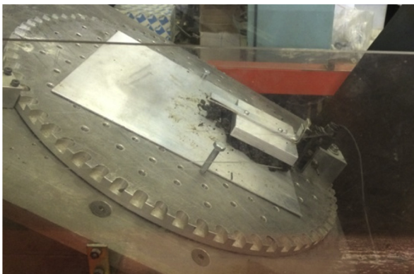
Fig. 5. Tilt test apparatus.
