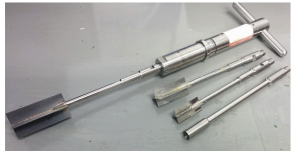
Fig. 6. Vane shear test apparatus.
