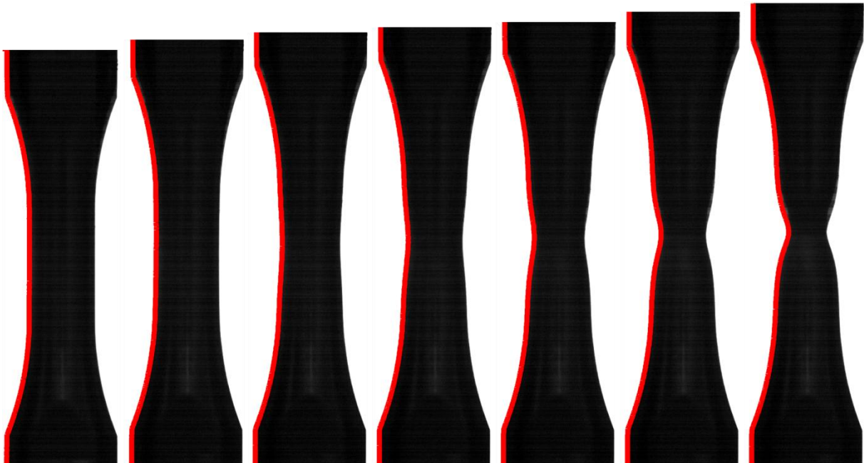
Figura 1: Esempio di elaborazione digitale dell'immagine per l'identificazione del profilo del provino in una prova di trazione: entrambi i lati del provino assialsimmetrico vengono rilevati e determinato il profilo medio dei due.
