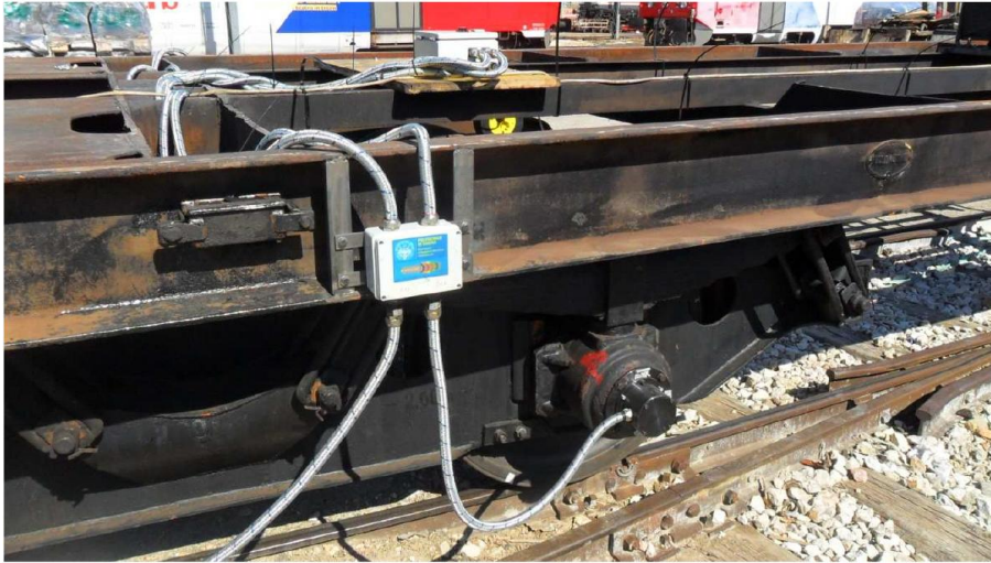
Figura 13: Sistema di monitoraggio Multicanale per un singolo carrello.
