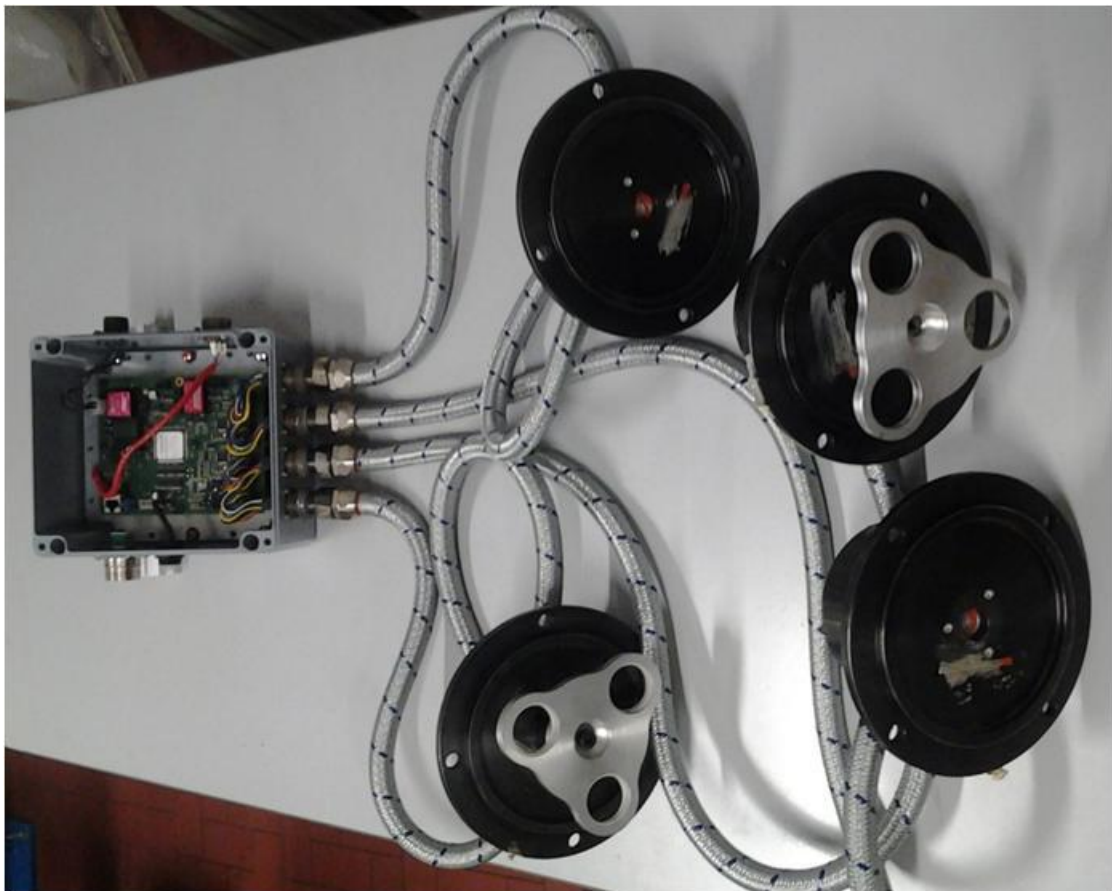
Figura 3: Sistema di monitoraggio Multicanale per un singolo carrello.
