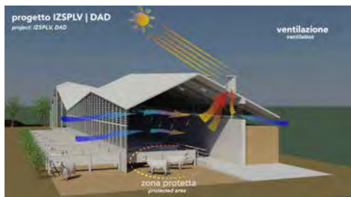
Ventilazione naturale della stalla attraverso camino solare. È necessario garantire il ricambio dell'aria interna mantenendo i bovini in un'area protetta, non esposta a correnti dirette.
