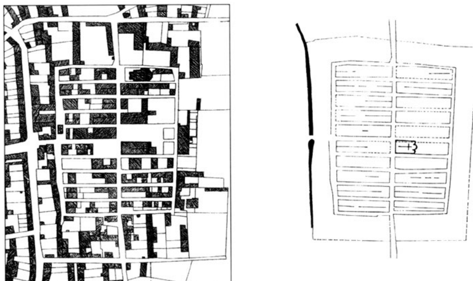
18. Buttigliera d'Asti: analisi del parcelle e schema ricostruttivo della matrice, scala 1:5000 (da MARZI 2003 p. 80).
