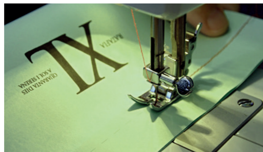
in alto e a destra: XL Ratafia, La Fonda Gràfica - Oriol Piferrer Saló, Cèlia Izquierdo & Marc Corominas, Spagna, 2012. Si tratta di un liquore artigianale che richiama il proprio nome attraverso un'etichetta extra large cucita a macchina e infilata sulla bottiglia senza far uso di collanti.
