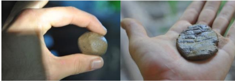
Izq. Esquema de prueba de exudación según bibliografía (CraTerre1969)
