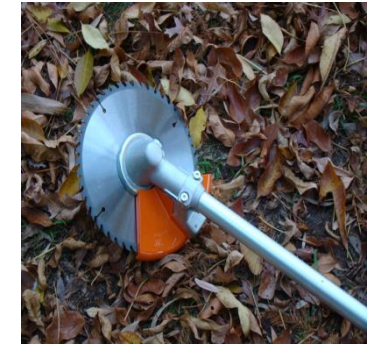
Secuencia del manejo de bambusal ya manejado. De izquierda a derecha: eliminación periódica de malezas y cañas secas, marcado y selección de cañas, corte selectivo de culmos al ras del nudo inferior y sierra circular adaptada para facilitar el corte (fuente: Lic. Clara Peña DPDI)
