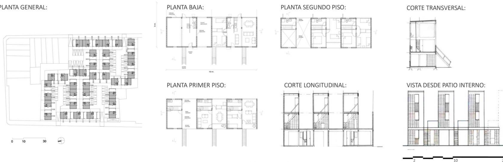
De izq. a der. Planta del conjunto donde se aprecian los cuatro patios. Plantas de las diversas unidades y posibilidades de ampliación. Secciones y vistas de las unidades entregadas. Fuente: Favelas Learning from, Lotus Internazionale 143, Edizioni Lotus, Milan
