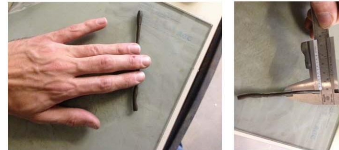
Izq. secuencia de pasos para la obtención del límite plástico (CraTerre 1969) Der. Determinación del límite plástico para la muestra I. FOTO: ECMV: 30-11-2014
