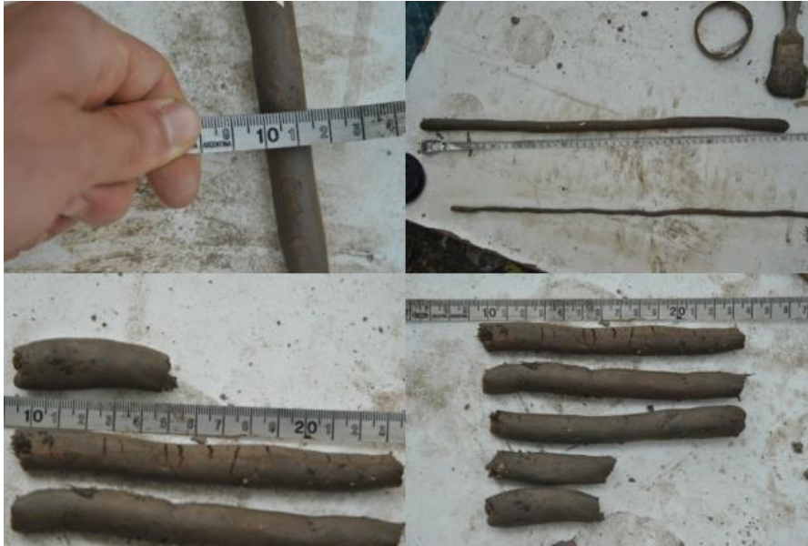
Pruebas de consistencia de la muestra V. Foto: Alberto Bondavalli para la DPDI y Construir con el Delta 20-11-2014
