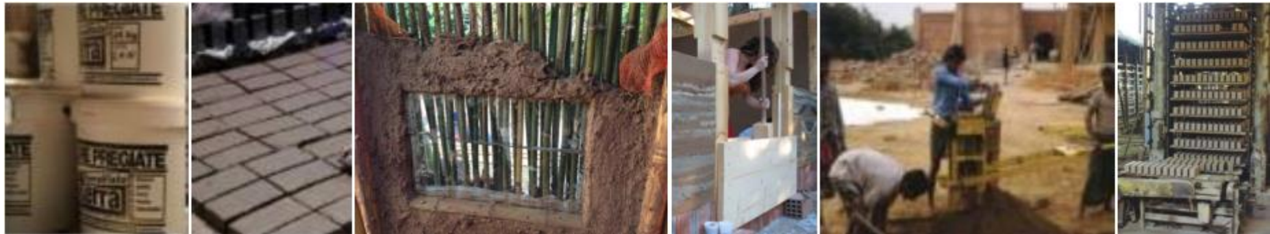
Productos para la edificación en sus distintas elaboraciones. De izquierda a derecha: revoques premezclados. Secado de ladrillos de adobe, sistema de muro tipo quincha con panel prefabricado (foto EM 04-05-2014), sistema tipo Tapial, fabricación de bloques y fábrica de ladrillos en tierra (fuente Minke 2006)
