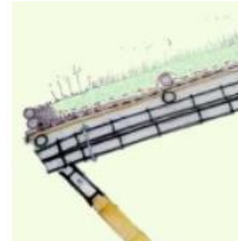
Construir con el delta: Techo extensivo realizado sobre estructura de bambú, combinando materiales reciclados y técnicas convencionales. De izquierda a derecha: Techo terminado (8-12-2014) , detalle y proceso constructivo (20-04-2014) (Fotos: EM y Clara Peña )
