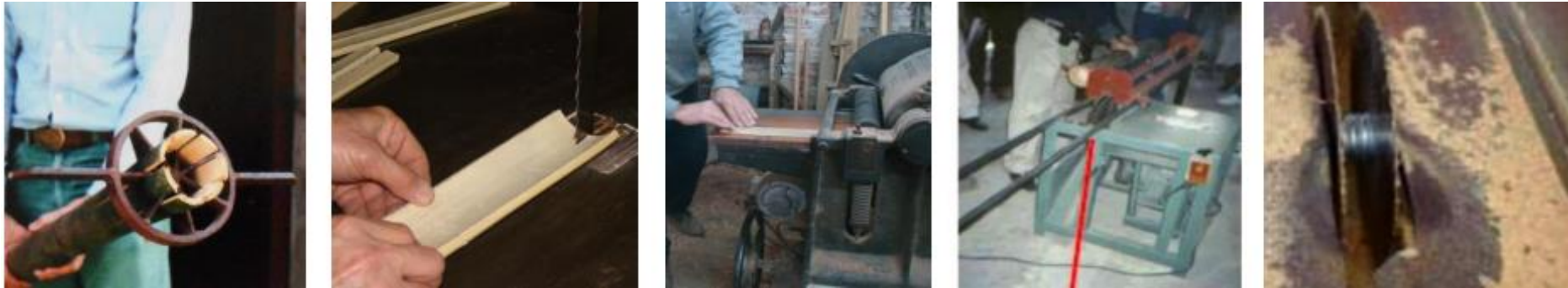
Herramientas para la elaboración de bambú. De izquierda a derecha: Cuchilla radial manual (fuente Minke 2012) Trabajo con cierra de banco y cepilladora simple en workshops de la DPDI 2008 (fuente: Lic Cara Peña ) Sierra especial doble, vista general y detalle (fuente Botero Cortés 2004)
