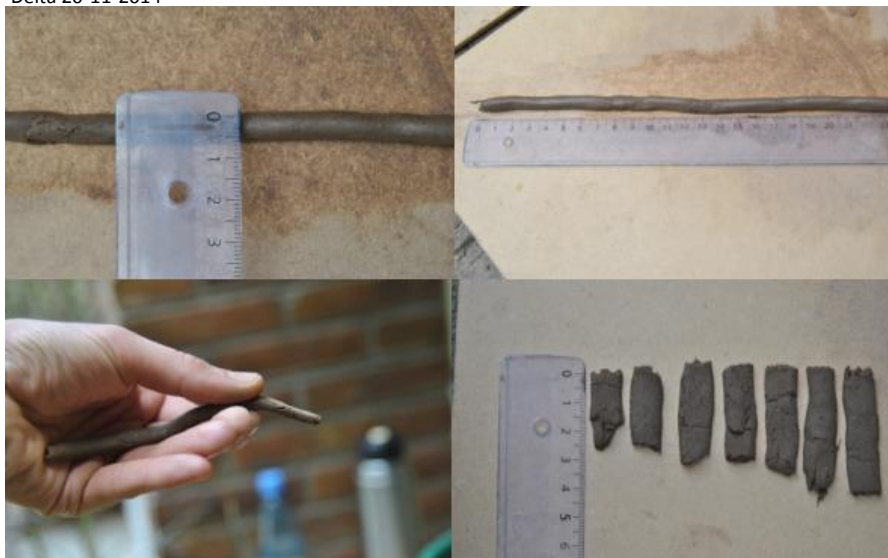
Pruebas de cohesión de la muestra I Foto: Alberto Bondavalli para la DPDI y Construir con el Delta 20-11-2014
