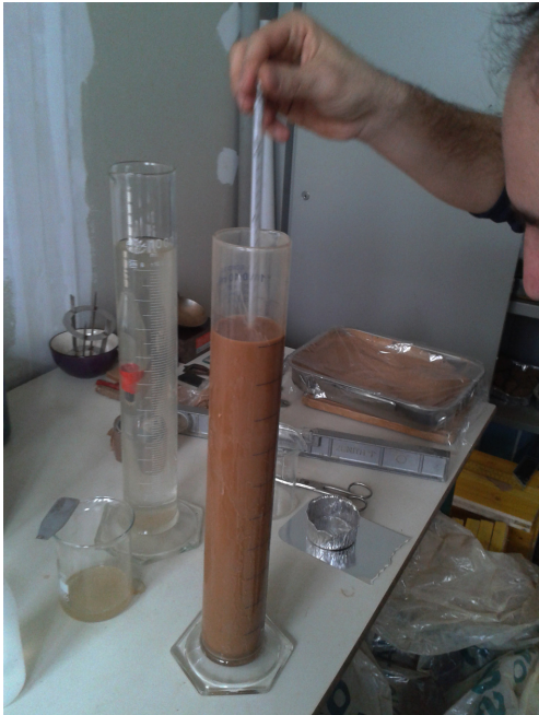
Fig. 7.32, A partire da 1 minuto viene presa la temperatura del fluido per effettuare le dovute correzioni in fase di calcolo.
