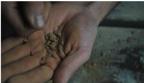
Fig. 7.20 - 7.21 Test di resistenza a secco: la pastiglia si spezza a metà e non si sbriciola: buon contenuto di argilla
