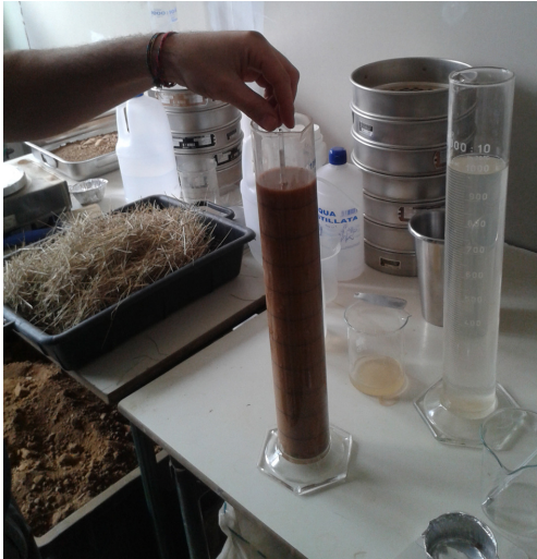
Fig. 7.31, Ad intervalli di tempo determinati viene effettuata una lettura del densimetro.
