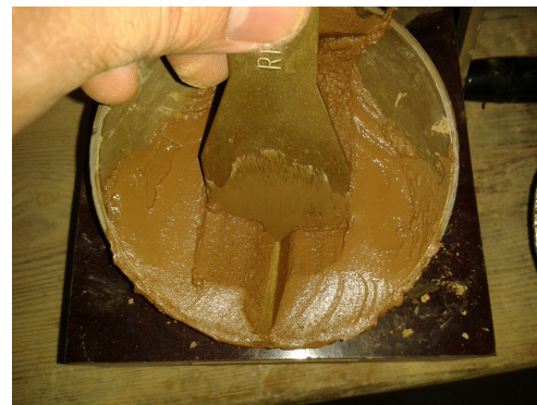
Fig. 7.39, Test del limite liquido con il cucchiaio di Casagrande; incisione del campione.
