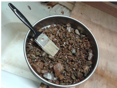
Fig. 7.24, Lavaggio della frazione grossa per separarla dalla parte fine.
