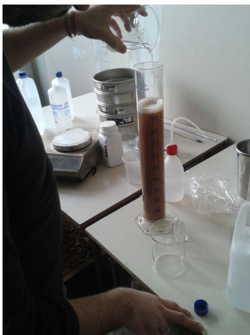
Fig. 7.29, Il deflocculante viene aggiunto alla soluzione di terra in acqua distillata.
