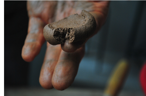
Fig. 7.15, Test di Consistenza: la pallina si schiaccia non presenta particolari fessure dopo lo schiacciamento e non si sbriciola: dovrebbe avere un buon contenuto di argilla.
