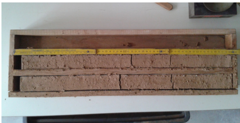
Fig. 7.13, Secondo il test di Alcock il terreno esaminato presenta un ritiro di 2cm sui 60 cm del cassero.
