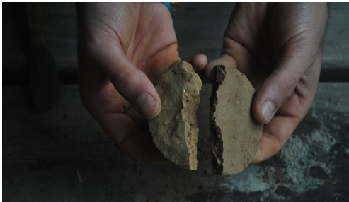
Fig. 7.18 - 7.19, Test di Trasudamento: la pallina preparata viene battuta; sono stati necessari 30 colpi per ottenere un lieve trasudamento superficiale.
