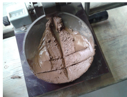
Fig. 7.40, Raggiunto il numero di colpi necessario alla chiusura del solco, viene asportata una parte del campione, pesata, essiccata in forno e ripesata una volta secca.
