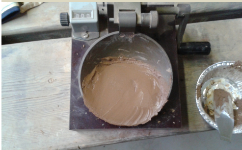
Fig. 7.35-7.36, Test del limite liquido con il cucchiaino di Casagrande; preparazione di uno dei campioni di terra per la prova
