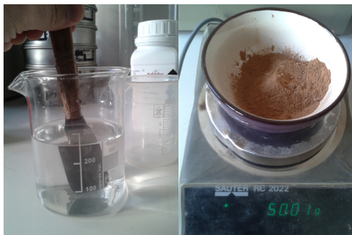
Fig. 7.27-7.28, Preparazione della soluzione deflocculante e pesatura del campione di terra da analizzare con il metodo della sedimentazione.
