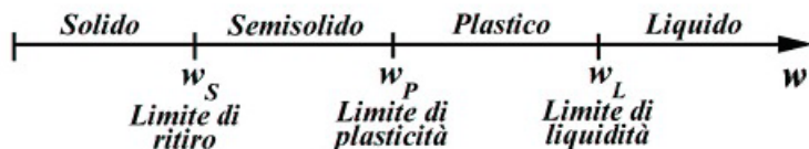
Fig. 7.34. Grafico che mostra i passaggi di stato del terreno ed i limiti ad essi associati. (da Cancellieri 2008)
