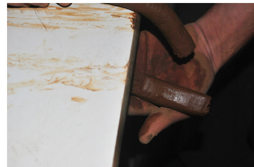
Fig. 7.16 - 7.17, Test di Coesione: preparazione del cilindro con terra allo stato plastico; il cilindro scivolando sulla superficie del tavolo si spezza in monconi di dimensioni tra i 9 e i 12 cm: medio contenuto di argilla.
