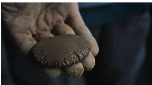
Fig. 7.18 - 7.19, Test di Trasudamento: la pallina preparata viene battuta; sono stati necessari 30 colpi per ottenere un lieve trasudamento superficiale.
