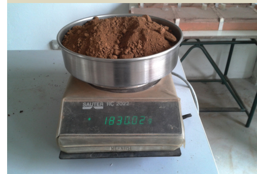
Fig. 7.22-7.23 Essiccazione in forno e pesatura di parte del campione di terra utilizzato per l'analisi granulometrica.
