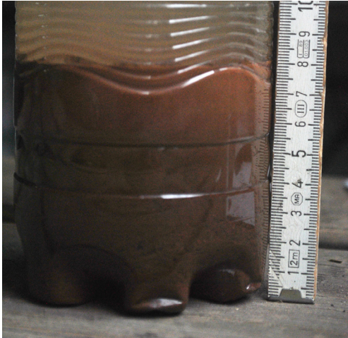
Fig. 7.12, La prova di sedimentazione indica un terreno ricco in sabbia e ghiaia, seppur fine, i risultati non collimano con quelli delle altre prove.
