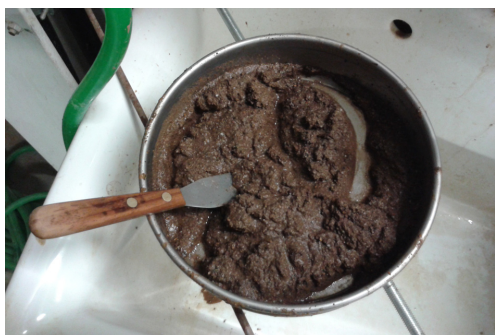
Fig. 7.25, Il lavaggio della frazione fine consente di separare la parte sabbiosa che rimane sul setaccio da limo e argilla che invece vengono recuperate insieme all'acqua all'interno di una vasca.
