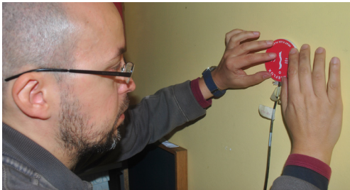
Fig. 6.40, 6.41, Posizionamento dei termoflussimetri con pasta adesiva per la misurazione del flusso di calore passante attraverso la parete N-O dello studio al primo piano, durante il monitoraggio invernale.
