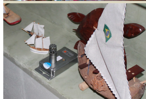
Fig. 6.38, 6.39, Posizionamento del Datalogger B, all'interno del salotto per il monitoraggio delle temperature interne estive.
