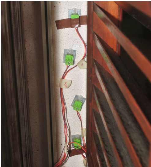
Fig. 6.42, Posizionamento delle sonde sulla superficie esterna del muro N-O durante il monitoraggio invernale.
