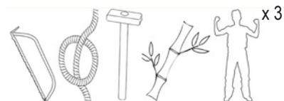
Segare delle canne di bambù aventi un diametro di 10 cm circa in segmenti di due lunghezze diverse. Con una mazza, piantare fin dentro la parete le canne più lunghe, passando attraverso fori realizzati in precedenza nel cordolo superiore. Con del filo di ferro, legare questa canna di bambù ad altre due più corte, per realizzare un incastro a baionetta.
