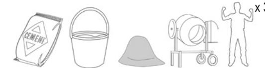
Preparare il calcestruzzo in una betoniera con le seguenti proporzioni: 1 parte di cemento, 1 parte di inerte (sabbia e ghiaia), 1 parte di acqua. Una volta che l'impasto è ben amalgamato, gettarlo all'interno dello scavo. Assicurarsi che il calcestruzzo riempia tutti gli spazi tra i ferri d'armatura, le barre filettate e il terreno. Lasciare maturare il getto all'ombra per circa tre giorni; è necessario bagnarlo di tanto in tanto con un po' d'acqua, in modo che non crepi.
