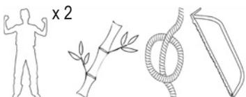
Legare insieme due canne di bambù e piantarle nel terreno (creare due coppie di pilastri). Con altre aste della stessa dimensione costruire un telaio rettangolare ancorandogli sopra un foglio di canniccio. A questo punto, fissare un cilindretto di bambù alla sommità della parete e infilarci dentro gli spigoli del telaio appena realizzato. Facendo perno su questo punto, il telaio potrà ruotare fino ad appoggiare su un'asta amovibile che andrà appoggiata sui due pilastri.
