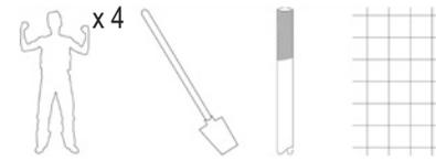
Tracciare lo scavo sul terreno e, in base alla composizione di quest'ultimo, determinare la profondità delle fondazioni. Conservare la terra smossa per impiegarla in fasi successive.
