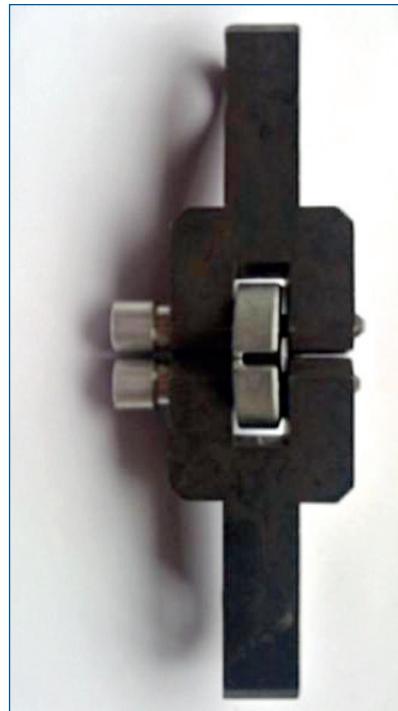
Fig. 2 - Provino montato sugli afferraggi per la prova di trazione.
