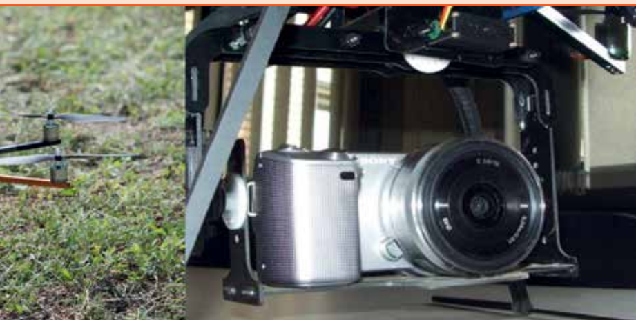
Fig. 1 - Sistema RPAS impiegato (sinistra) e camera installata (destra).
