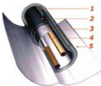
Figura 5 Pannello a tubi sottovuoto: 1- Vetro sottovuoto doppia camera, 2- Assorbitore selettivo, 3- Assorbitore in alluminio, 4- Tubazione lega rame-nichel, 5- Riflettore CPC (immagine: http://www.rossatogroup.com )
