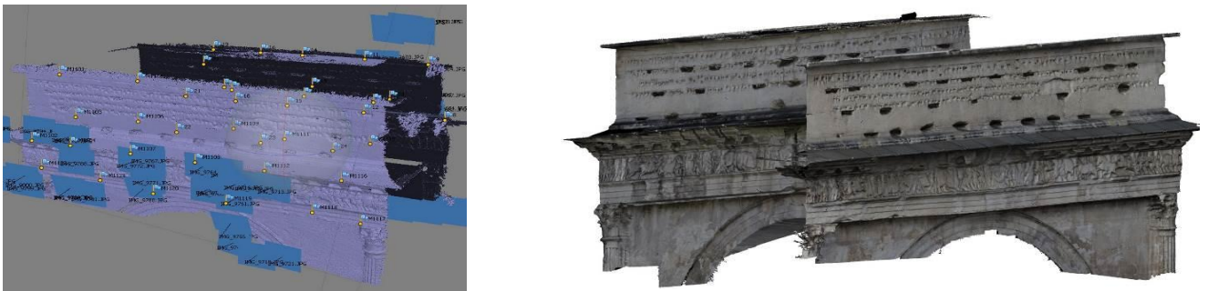
Figura 8 - A sinistra: mesh del fregio elaborata a partire dai dati fotogrammetrici; a destra: mesh del fregio texturizzata con ortofoto estratte dal modello fotogrammetrico.
