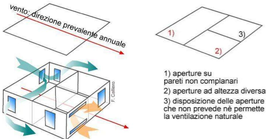
Figura 4: unità abitative con potenzialità di ventilazione naturale
