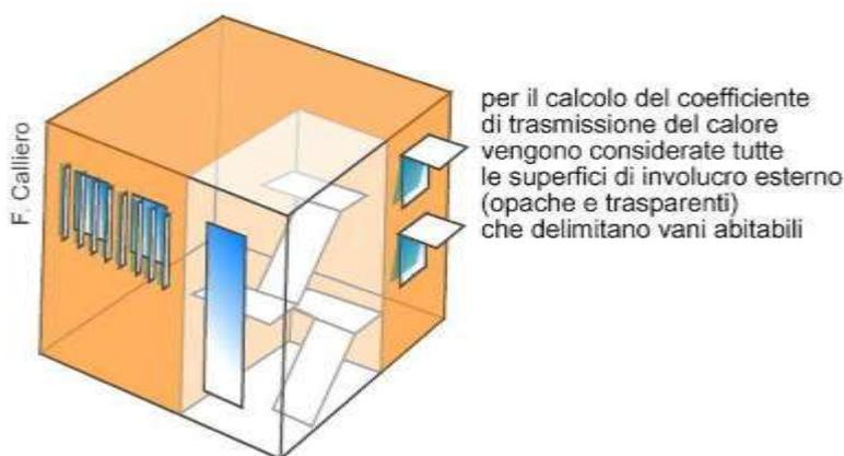
Figura 5: elementi considerati per il calcolo del coefficiente di trasmissione del calore medio ponderato
