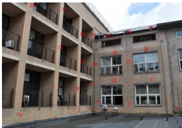
Figura 2 - Poligono di calibrazione (sinistra) ed esempio di modello di distorsione radiale stimato (destra)
