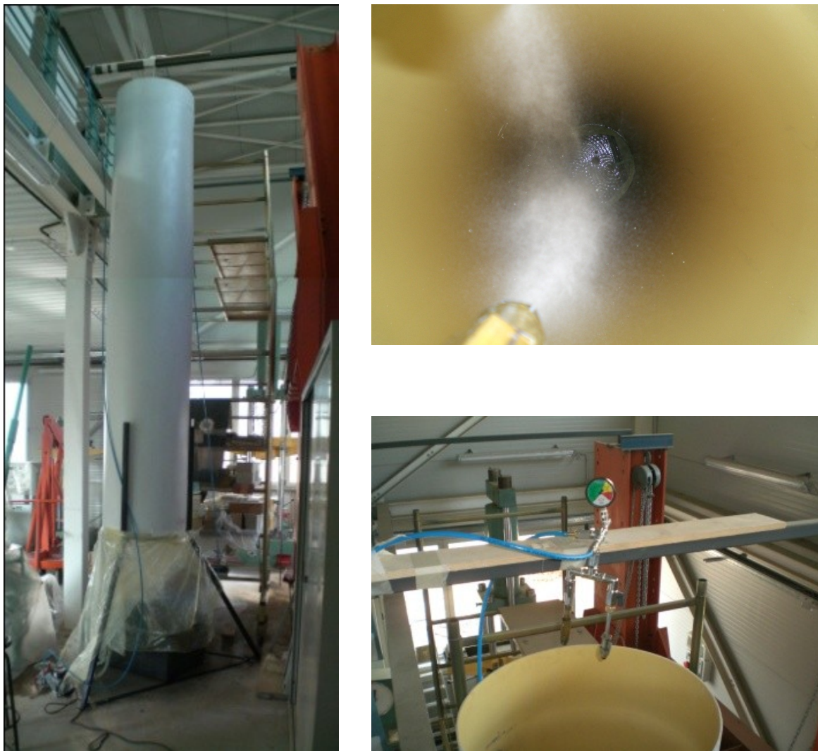
Fig. 5.7 - Immagini della torretta evaporativa diretta "Rain Shaft", installata nel Laboratorio "R. Mattone" e dell'ugello del tipo shower.
