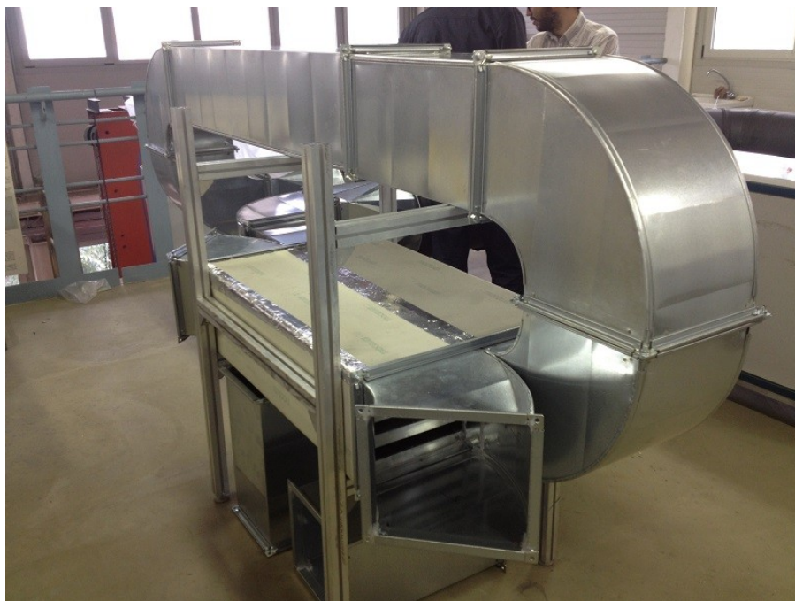
Il prototipo LoPHEX collegato al circuito prova per le misure di scambio
