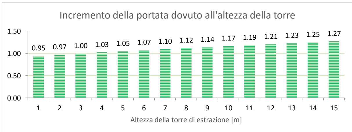
Figura 5.24d – Grafico dell’incremento della portata volumica, prendendo come valore base l’altezza di una torre di estrazione pari a 3 metri.
