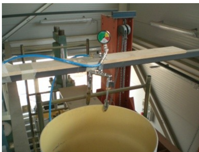
Fig. 5.7 - Immagini della torretta evaporativa diretta "Rain Shaft", installata nel Laboratorio "R. Mattone" e dell'ugello del tipo shower.
