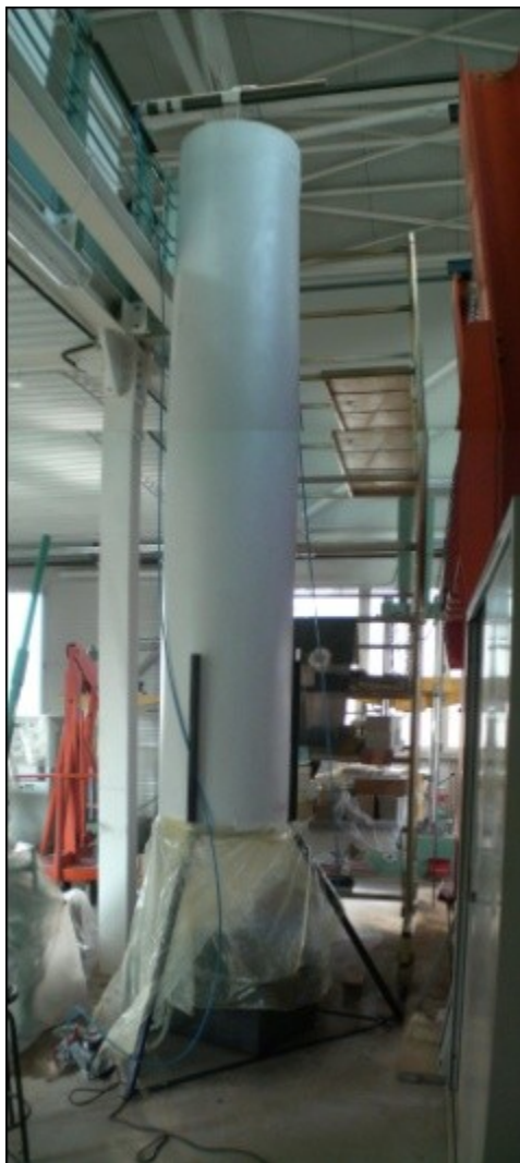
Fig. 5.7 - Immagini della torretta evaporativa diretta "Rain Shaft", installata nel Laboratorio "R. Mattone" e dell'ugello del tipo shower.
