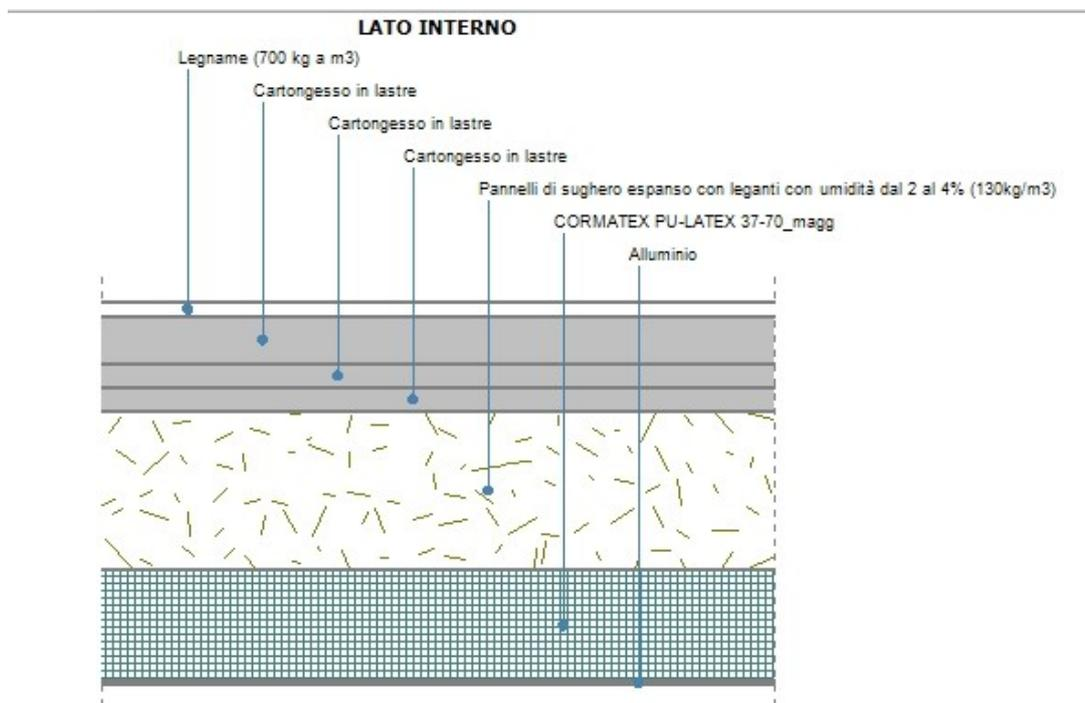
Fig. 4 - - Stratigrafia della chiusura opaca orizzontale inferiore
