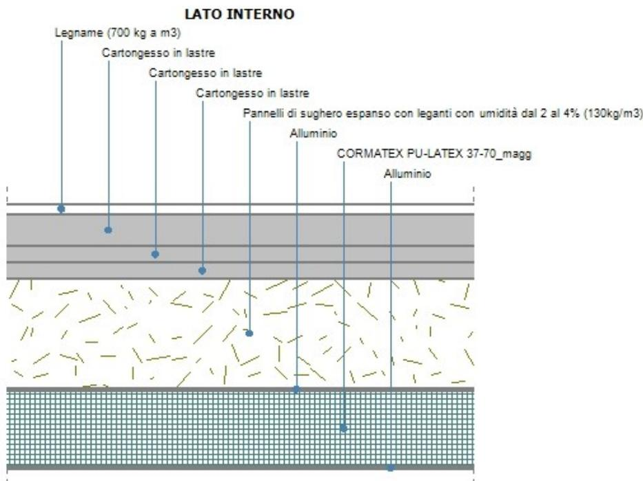
Fig. 5 – Stratigrafia della partizione orizzontale strutturale interpiano
