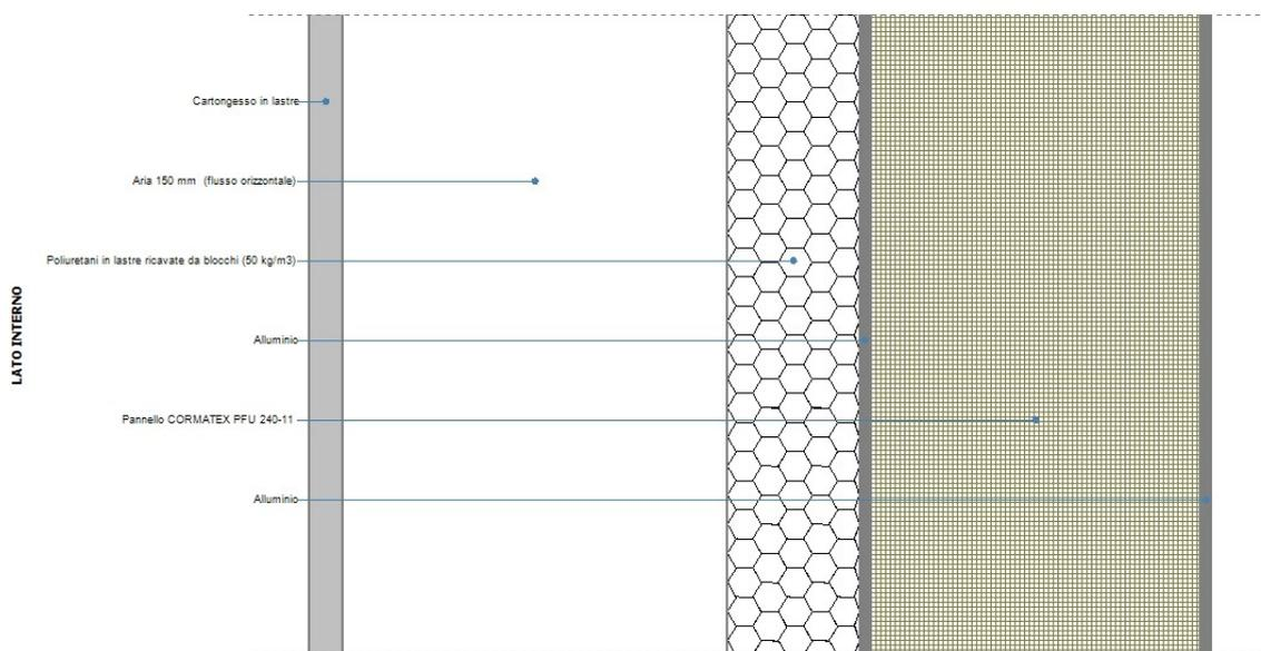
Fig. 2 – Stratigrafia della chiusura verticale opaca
