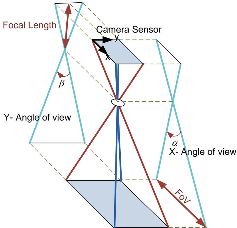
Figure 30. **Sensor Configuration**
