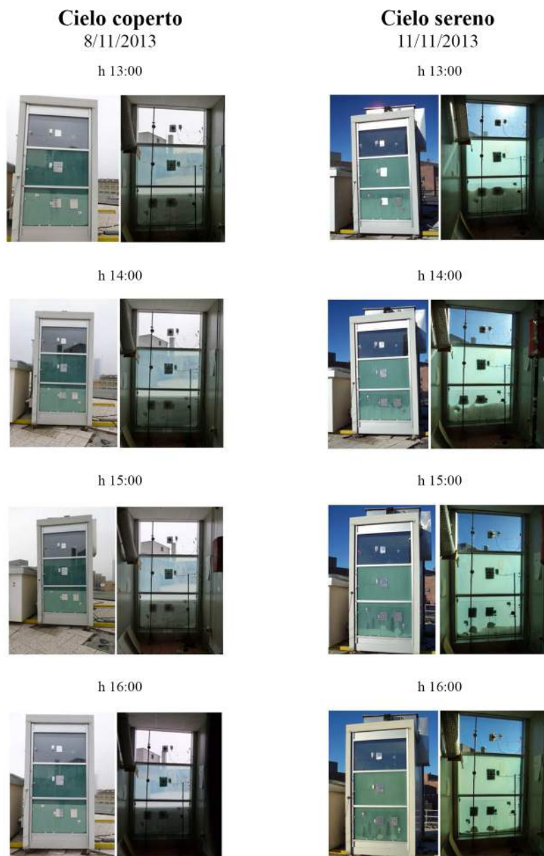
Figura 9.8: Confronto tra giornata a cielo coperto e a cielo sereno. Immagini all'esterno e all'interno della cella di prova dalle ore 13:00 alle 16:00.
