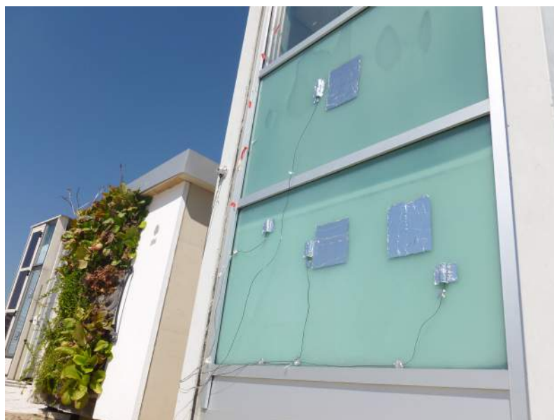
Figura 5.9: Test cell sulla copertura del dip. Energia del Politecnico di Torino. Schermatura dei sensori di temperatura e flusso termico con nastro alluminato.
