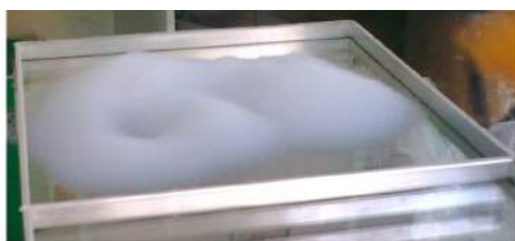
Figura 2.2: Posizionamento di areogel granulare nell'intercapedine di un vetrocamera.
