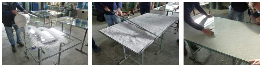
Figura 8.4: Assemblaggio del prototipo vetrocamera con PCM granulare CS1, presso l'azienda MBT.
