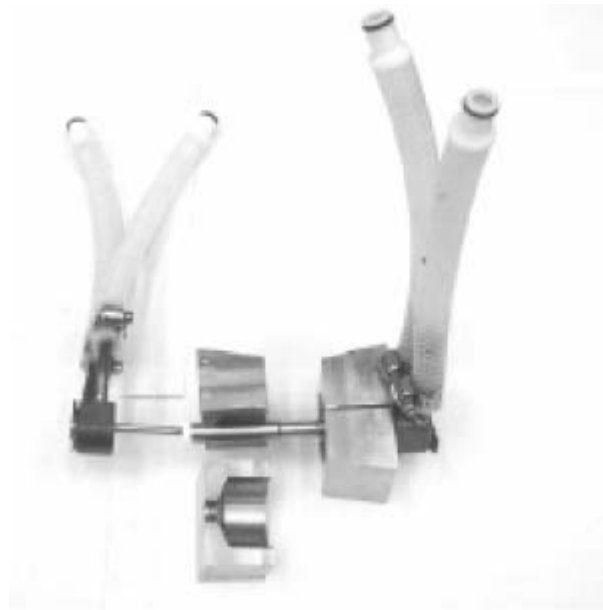
figura 4.10: campione e tubi di raffreddamento del Gleeble
