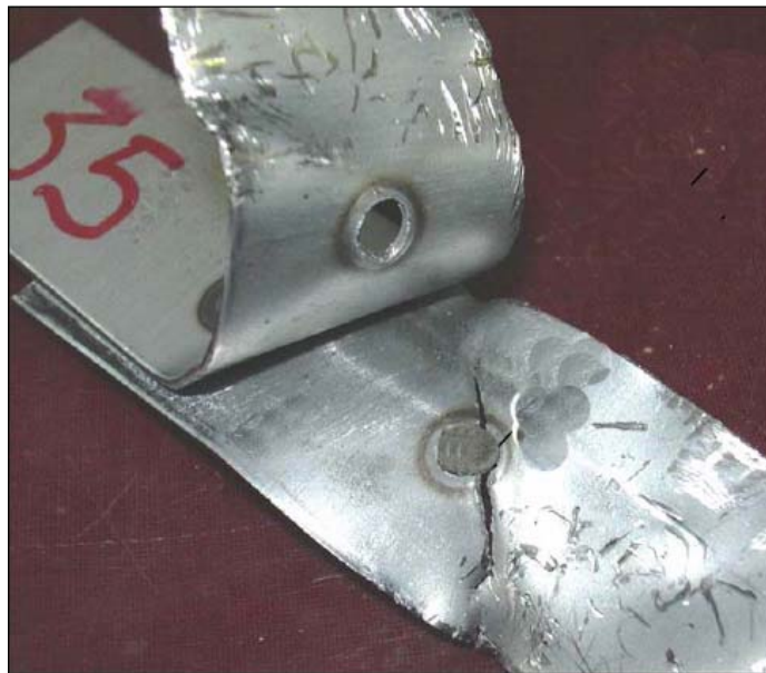
figura 6: provini aperti per sbottonatura
