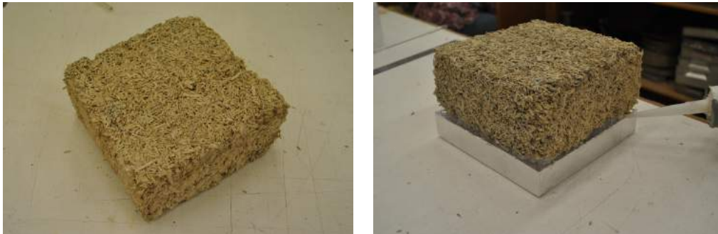
Figura C.4: Campione di calce canapa e sigillatura lacune tra il contenitore-base e il campione
