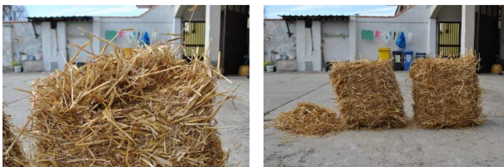
Figura A.9: Particolare della parte terminale della balla separata; balle separate e residuo paglia sfusa dopo il taglio
