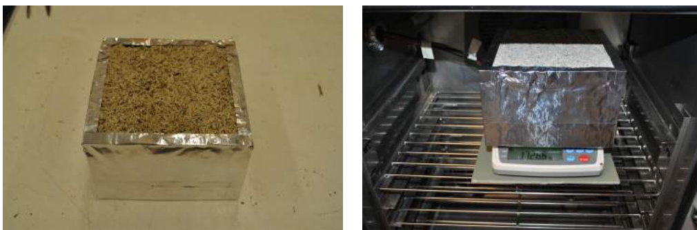
Figura C.5: Campione isolato con alluminio adesivo e collocazione in camera climatica
