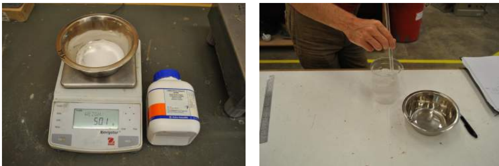
Figura C.3: Pesatura dei sali e diluizione in acqua
