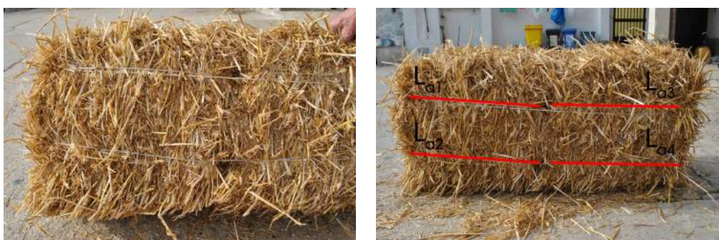
Figura A.6: Termine delle quattro legature; posizione delle legature nella balla
