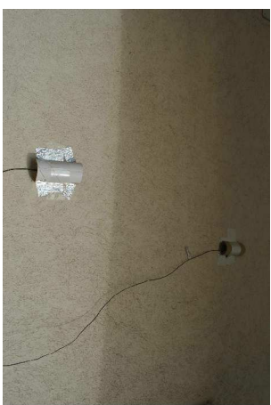
Sonde esterne schemate su chiusura esistente
