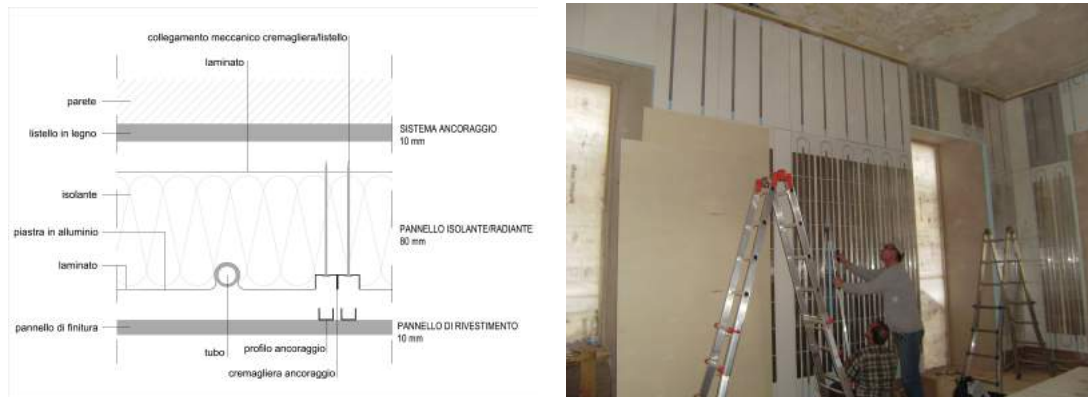
Figura 2.2: Esploso del pannello isolante con elementi radianti (Politecnico di Torino - DIST, 06 giugno 2013) e installazione pannelli isolanti radianti presso il caso studio dell'Hotel in piazza Carlina a Torino (Politecnico di Torino - DIST, 28.02.13)
