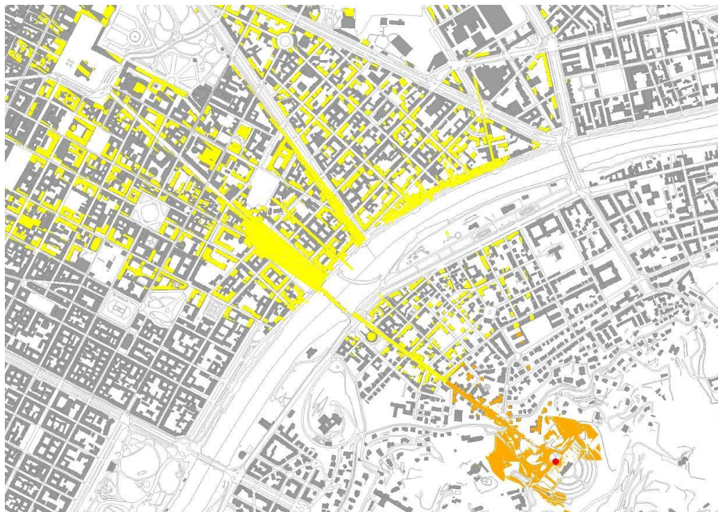
Figura 7. Analisi di visibilità su base cartografica DSM (DTM integrato con CTC Comune di Torino passo 1 m).
