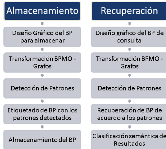
Figura 3.17: Fases de ejecución del repositorio. Fuente propia.
