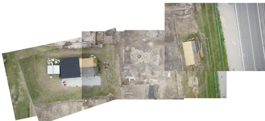
Figura 6: immagini relative al blocco fotogrammetrico acquisito sulla Domus, si notano le sovrapposizioni non costanti ed alcune rotazioni delle immagini
