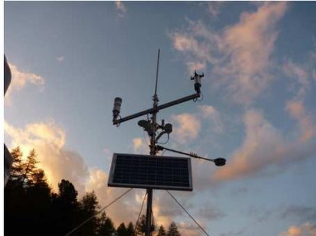
**FIGURA 87: POSIZIONAMENTO BRACCETTO SENSORI DEL VENTO E ALBEDOMETRO**
