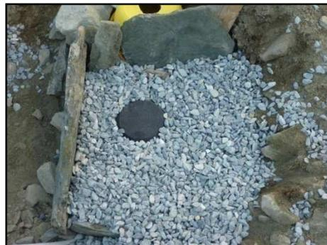
**FIGURA 52: LO STRUMENTO POSTO A 20 CM DI PROFONDITÀ È IN QUESTA FOTO PRIVO DEL RICOPRIMENTO MA CIRCONDATO DA UNO STRATO DI GHIAIETTO**
