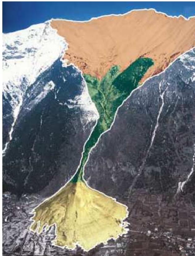
FIGURA 29: ZONA DI DISTACCO (ARANCIONE), ZONA DI SCORRIMENTO (VERDE) ZONA DI ACCUMULO (GIALLO) (TRATTO DA MANUALE AINEVA)
