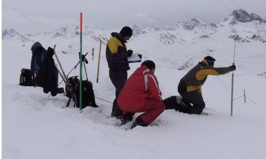
FIGURA 22: RESISTENZA ALLA PENETRAZIONE ESEGUITO CON LA GUARDIA DI FINANZA DI ENTRÈVES
