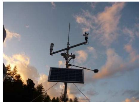
FIGURA 99: NUOVO POSIZIONAMENTO CON IL BRACCETTO PER DISTANZIARE I DUE SENSORI
