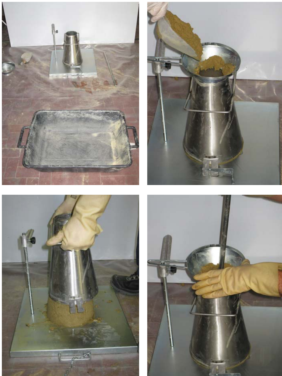
Figura 2. Procedura di prova. In senso orario: attrezzatura, riempimento, costipazione, sollevamento.
