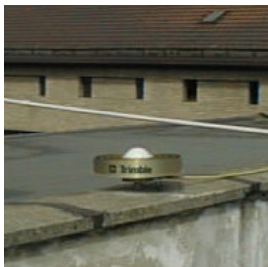
Figura 5. stazione permanente GPS al Politecnico di Torino, attiva dal 1996
