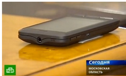
Figura 11. Cellulare con ricevitore GLONASS integrato
