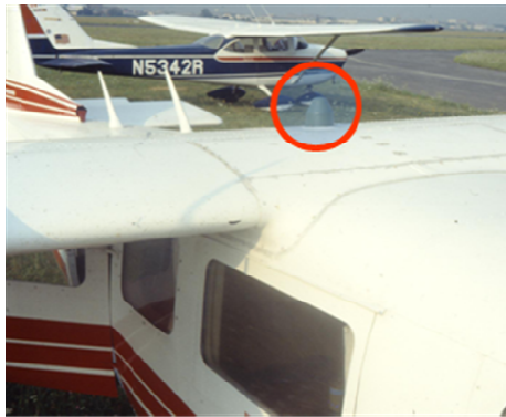
Figura 4. antenna GPS cinematica su aereo per riprese fotogrammetriche (1990)
