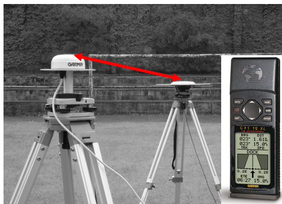
Figura 17. ricevitore e antenna GARMIN con adattatore e determinazione della posizione del centro di fase
