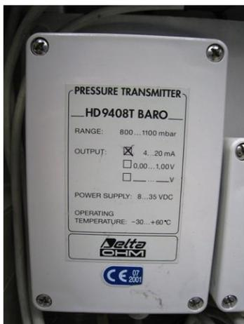
Figura 2-46 - Sensore pressione ambiente pb
