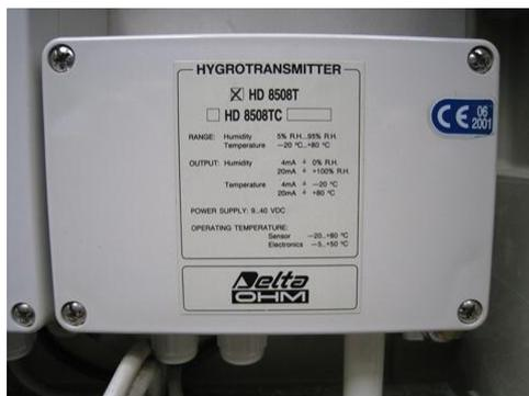
Figura 2-47 - Sensore umidità ambiente RH0
