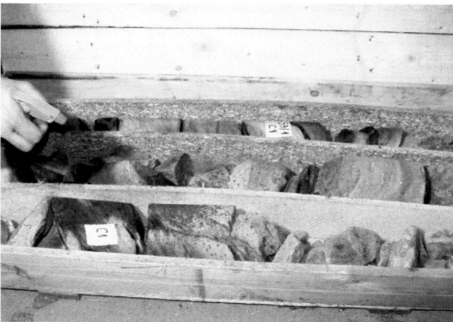
Fig. 7 – Fasi di campionamento. La nebulizzazione d'acqua riduce la dispersione di fibre. Phases of sampling. The water spray reduces the dispersion of fibers.
