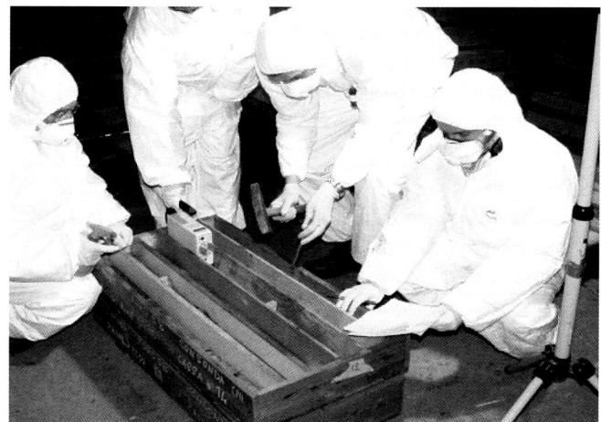
Fig. 7 – Fasi di campionamento. La nebulizzazione d'acqua riduce la dispersione di fibre. Phases of sampling. The water spray reduces the dispersion of fibers.
