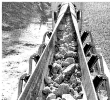
Figure 10a e 10b – Nastro trasportatore tubolare "chiuso" e nastro trasportatore aperto (al carico ugelli nebulizzatori). Pipe conveyor belt and open conveyor belt (with nebulizers).
