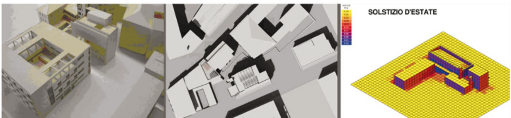
Fig. 3 L'evoluzione delle tecniche per la valutazione dell'incidenza solare: dalla produzione di maquette, ai tradizionali strumenti digitali per valutazioni di tipo qualitativo, alla stima numerica (kW/mq) ottenuta con le nuove tecnologie informatiche..
