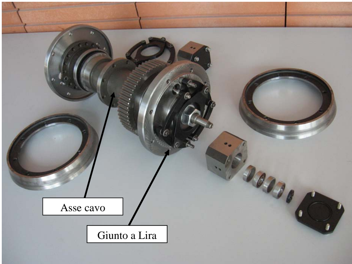
Figura 11: Dettaglio del sistema di trasmissione a lira.
