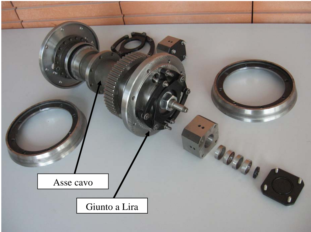
Figura 11: Dettaglio del sistema di trasmissione a lira.
