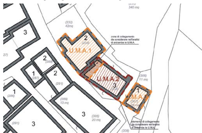
[Fig. 19 - Ranco - esempio di individuazione dell'Unità Minima di Analisi - Scala 1:500 - elaborazione DICAS]
