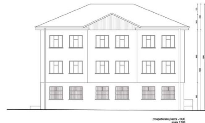
[Fig. 25 - ex scuola di Sampeyre - rilievo stato di fatto - prospetto fronte sud - DICAS]
