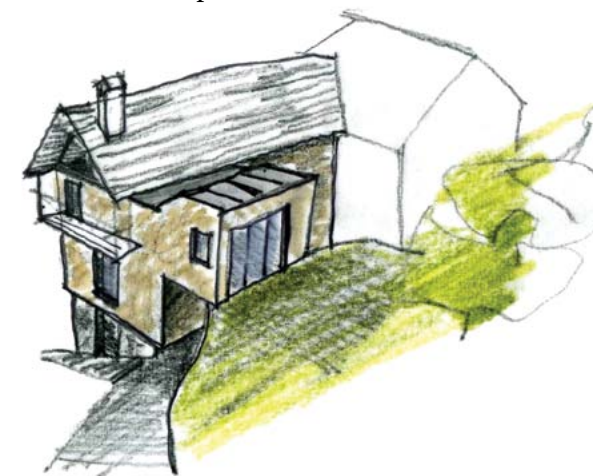
[Fig. 23 - ipotesi di possibile intervento senza mimetismi per l'aumento di cubatura. Mantenimento delle caratteristiche originarie della preesistenza - schizzo volumetrico]
