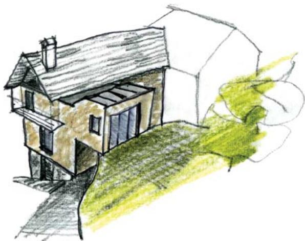
[Fig. 26 - ipotesi di possibile intervento senza mimetismi per l'aumento di cubatura. Mantenimento delle caratteristiche originarie della preesistenza - schizzo volumetrico]
