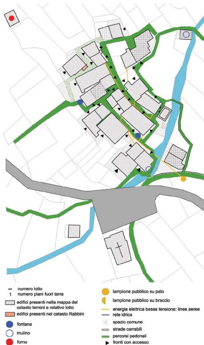
[Fig. 12 - accessibilità e dotazione di servizi - scala 1:1000]
