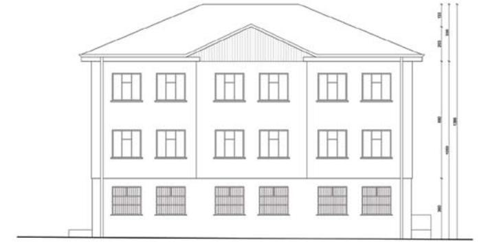
[Fig. 9 - ex scuola di Sampeyre - rilievo stato di fatto - prospetto fronte sud - DICAS]
