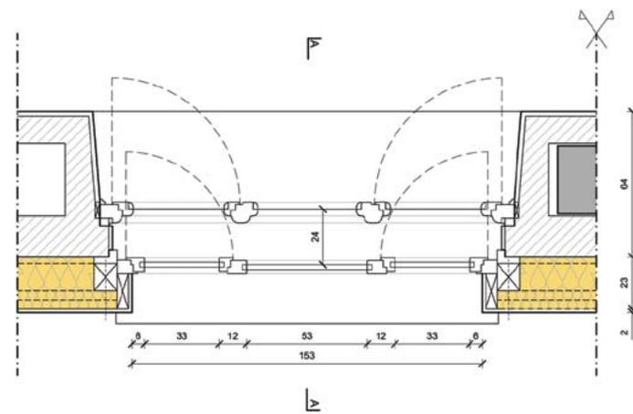
[Fig. 13 - ex scuola di Sampeyre - disegno tecnico della possibile soluzione di isolamento e raddoppio del serramento - DICAS]
