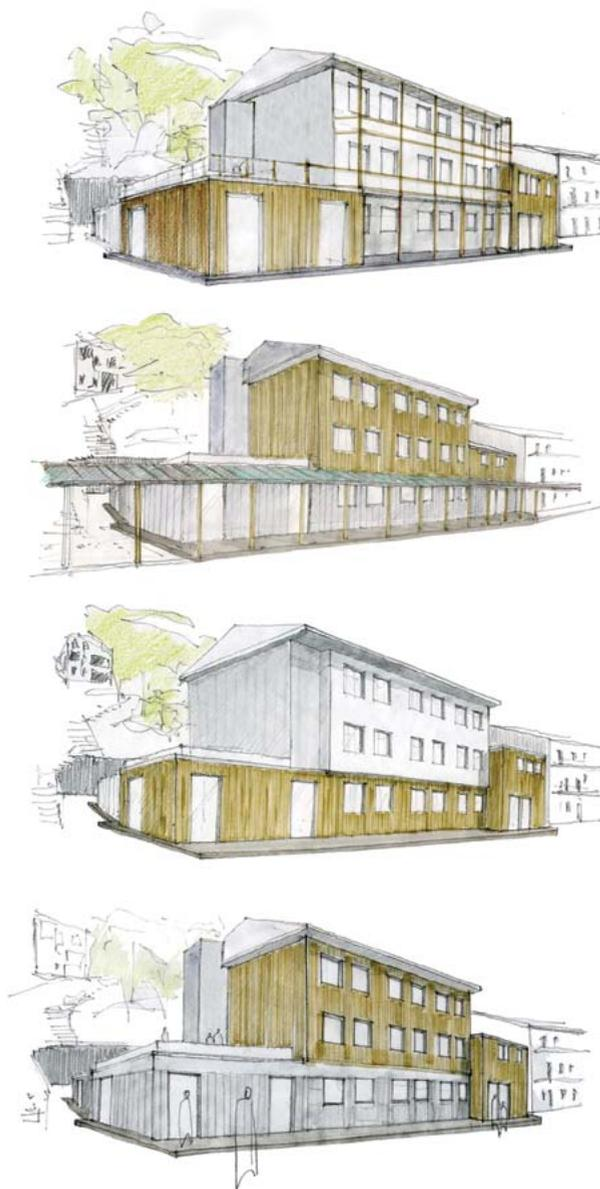
[Fig. 20 - disegni prospettici da sud-ovest - differenti ipotesi di ampliamento e rivestimento - soluzione con serra disposta a sud e porticato sottostante, ampliamenti rivestiti in legno, basamento in pietra; portico a sud con basamento piano terra in pietra e corpo in legno; basamento e ampliamenti in legno, corpo intonacato; corpo e ampliamento a est in legno, basamento piano terra in pietra - DICAS]
